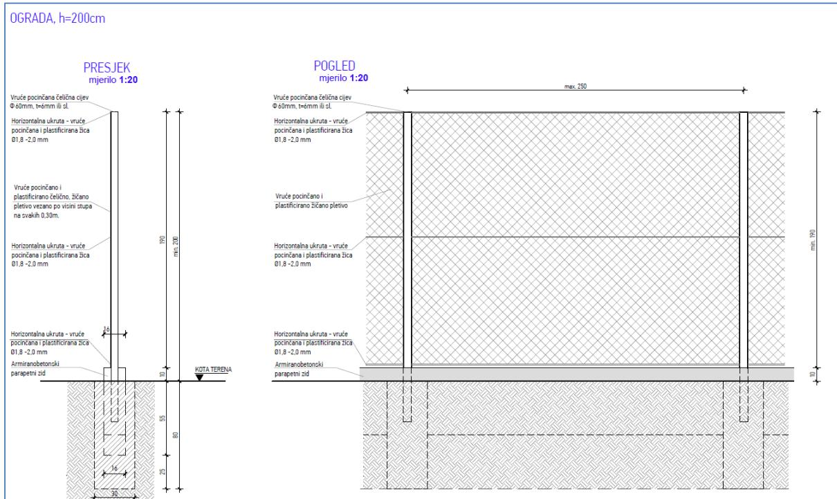
Cijelo područje UPOV-a bit će ogradio ogradom od čelične mreže. Ograda će biti postavljena na betonski zidić 10 cm iznad kote terena. Visina ograde je 2 m.
